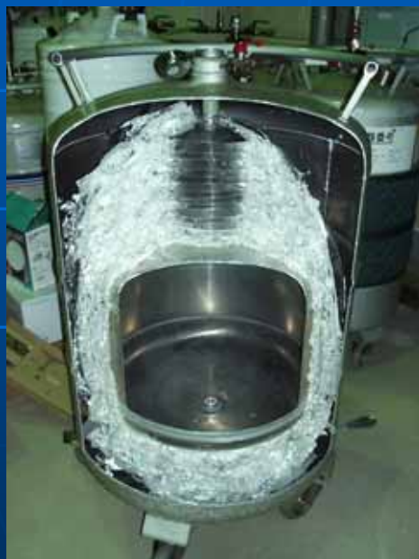
液体ヘリウム容器の 内部構造
